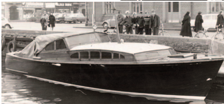
Das 11,25 Meter lange Motorboot wurde aus Föhre auf Eiche gebaut.
