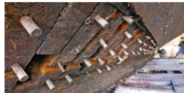
Holznägel am Rumpf des Lotsenschoners, mit denen die ursprüngliche Kupferbeschlagung angebracht war.
