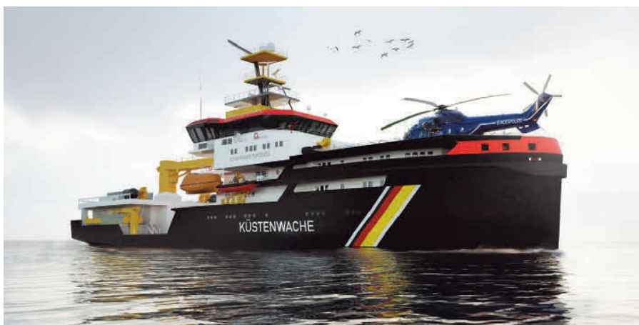
Die neuen Spezialschiffe sind 95 Meter lang und werden mit Flüssiggas betrieben. Rechts: Das Werftgelände von A&R mit Superyachten.
