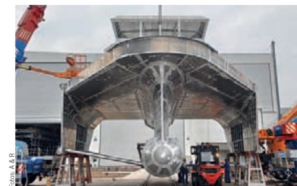
Die 20 Meter lange Swash-Konstruktion „Explorer“, aus Aluminium gebaut, verdrängt 65 Tonnen.
