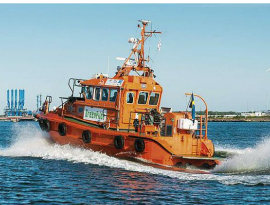
Methanol-Produktion aus Windenergie. Das schwedische Lotsenboot „Green Pilot“ fährt seit über zwei Jahren zuverlässig mit einem mit Methanol betriebenen Motor.
